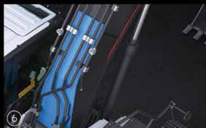
⑥ Estructura de pluma reforzada
